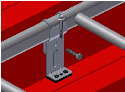
Kuva 6 Lapetikkaan korocejalan kiinnitys
